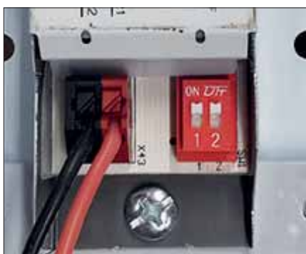
Dip switch per la selezione della corrente in uscita Equipped with dip switch for selection the output current
