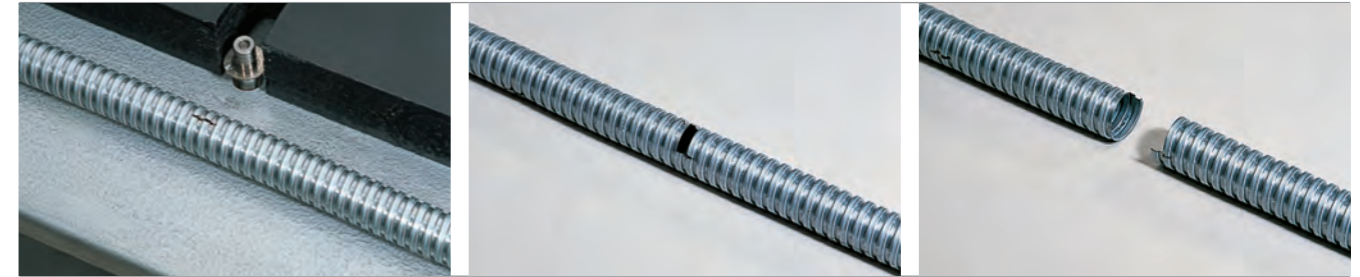
Trennschnitt in Längsrichtung des Schlauches über 1 bis 2 Schlauchgänge Cut longitudinally across 2 hose covering segments
