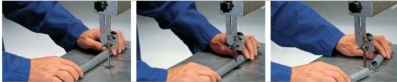
Schlauch im rechten Winkel zum Sägeblatt ansetzen Position conduit at right angles to band saw
