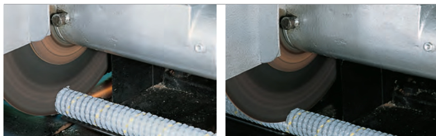
Schlauch im rechten Winkel unter der Trennscheibe fixieren Position conduit below cutting disc (90°)
