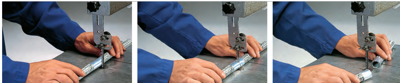
Trennstelle ca. 2-3 x mit Metall-Klebeband umwickeln Bind conduit with metal adhesive tape at the cutting position 2 or 3 times
