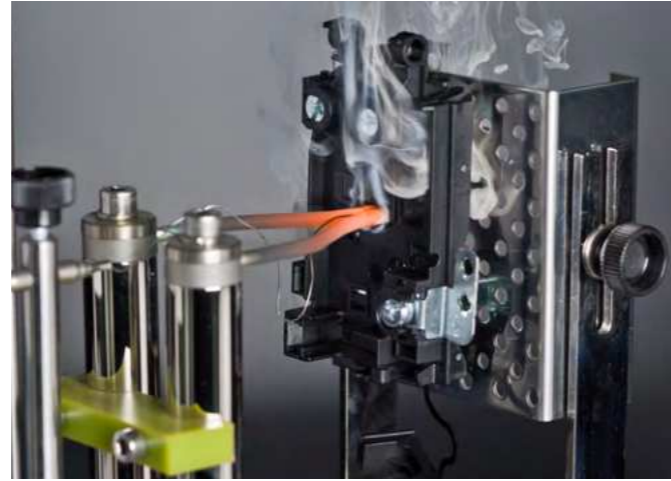
Glühdrahtprüfung (KADO) Glow wire test (KADO)
