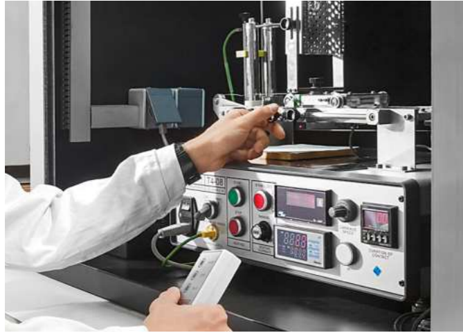
Glühdrahtprüfgerät Glow wire test device
