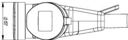
Gummi 3-fach Kupplung bel./franz System, Mittenschuttkontakt. Mit Dichtwulstverrastung, Shuttern und Deckeln. Vorverdrahtet, anschlussfertig auf Hauptklemme.
